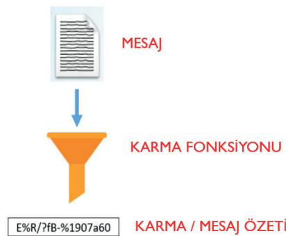
Şekil 4. Hash algoritmalarının çalışma mantığı
